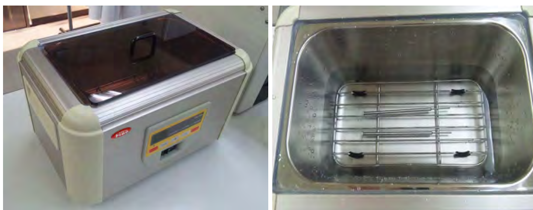
左が超音波洗浄機で、右がシリンジをセットした様子を示している。
